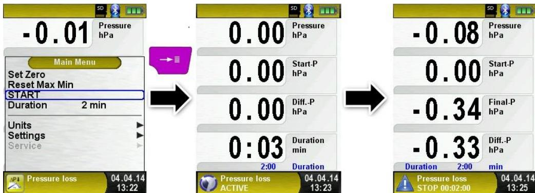
По истечении заданной продолжительности теста раздается звуковой сигнал, и в строке информации появляется сообщение "STOP pressure loss" ("Остановка анализа потерь давления"). Зафиксированные показания отображаются в главном окне, и пользователь имеет возможность вывести их впоследствии на печать в виде отчета или сохранить на карту MicroSD.
