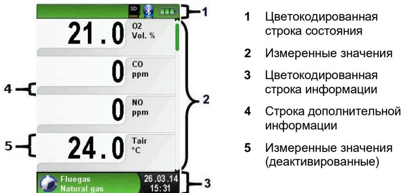
Рисунок 6: Окно программы измерения (пример для анализа дымовых газов)
