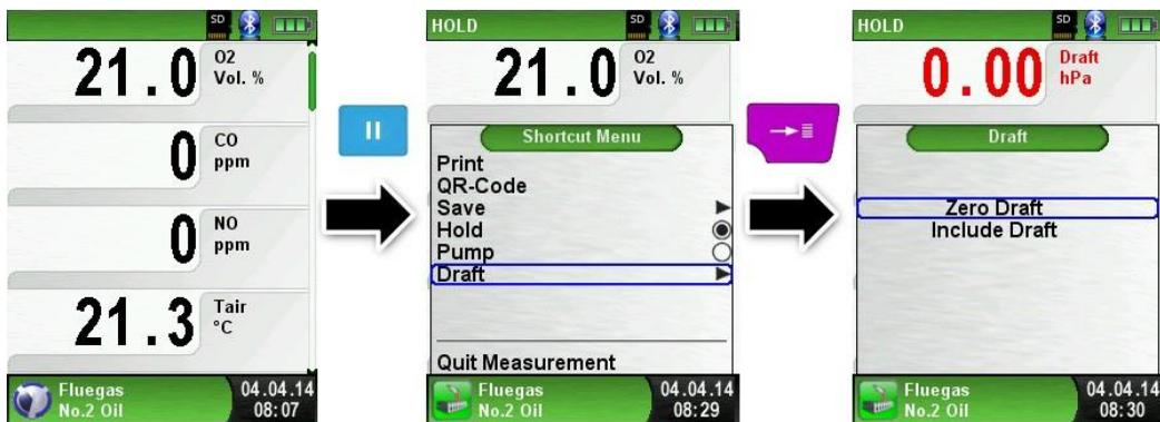
Измеряемое значение тяги непрерывно отображается в главном окне (красным цветом). После подтверждения значения тяги с помощью функции "Include Draft" ("Включить данные тяги") это значение будет включено в запись и будет отображаться черным цветом.
