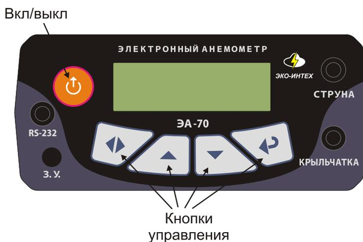
Рис. 5.1. Электронный анемометр ЭА-70 (0) (передняя панель)
