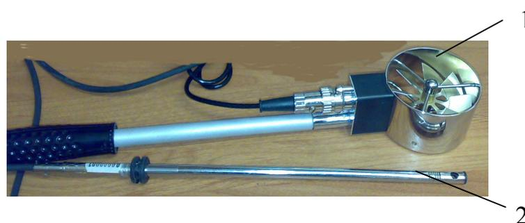
Рис. 5.2. Зонды к ЭА-70: 1 – зонд-крыльчатка, 2 – «обогреваемая струна».
